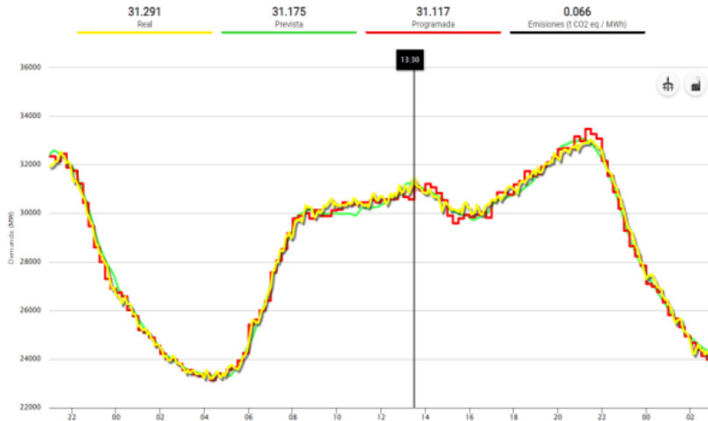
Figura 21. Curvas de demanda real, prevista y programada del miércoles 5 de junio de 2024. Fuente: REE.
