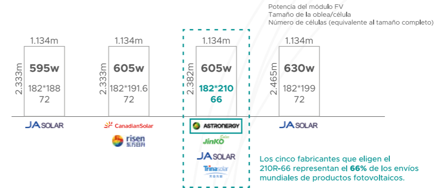
Figura 11: Obleas rectangulares adoptadas por los principales fabricantes.
